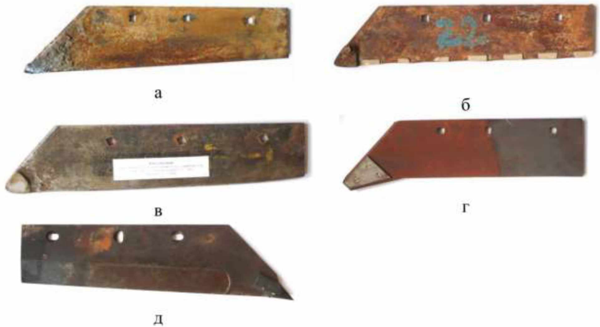
Рисунок 1.6 – Лемеші, зміцнені методами: а – наплавка; б – пайка пластин зносостійкого білого чавуну; в – приклеювання пластин з корундової кераміки; г – механічне закріплення пластини зі зносостійкої сталі; д – механічне закріплення конусної надставки зі зносостійкої сталі
