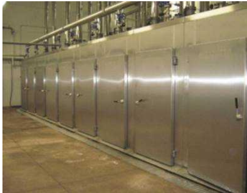
Рис. 2.5. Термічна обробка ковбаси у спеціальній автоматичній камері марки Autotherm D2-2-8/D
