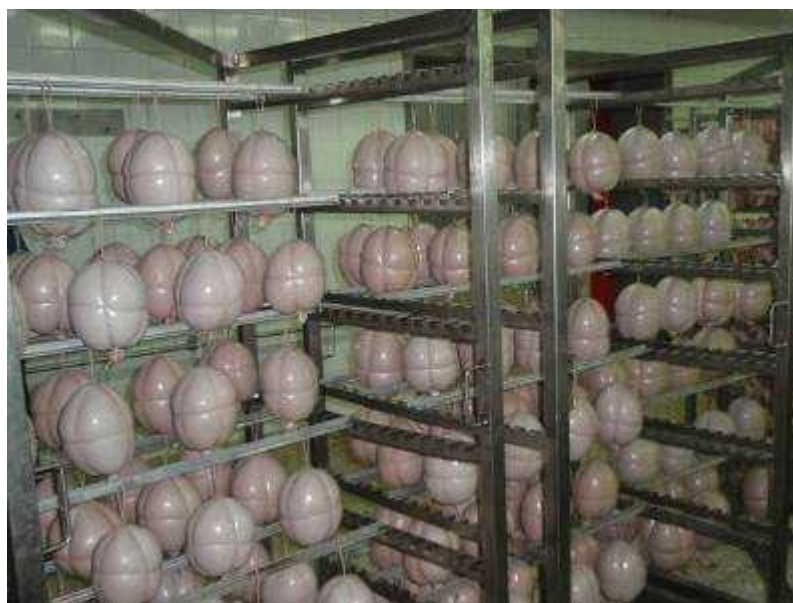
Рис.2.4. Осаджування вареної ковбаси «Лікарська»
