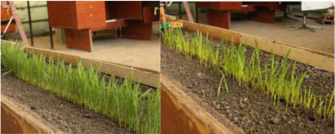
Рисунок 3.5 – Сходи після посіву із застосуванням вібрації (ліворуч) та без використання вібрації (праворуч) у лабораторних умовах
