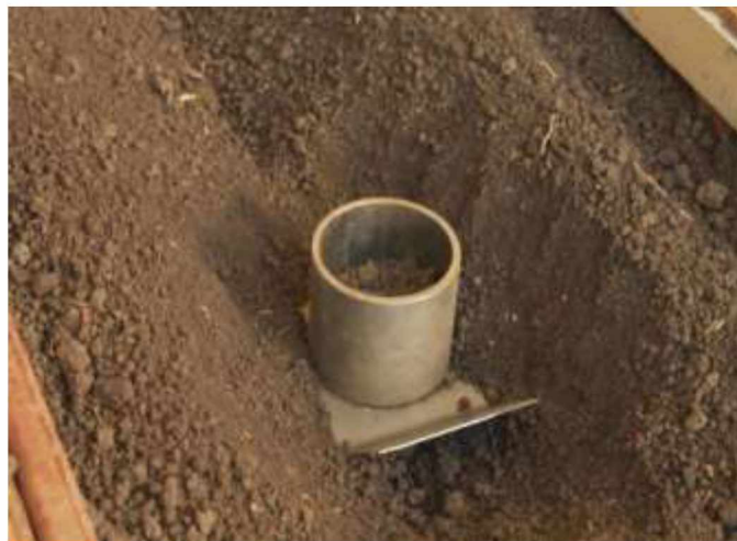
Рисунок 2.12 – Відбір проб для визначення щільності ґрунту
