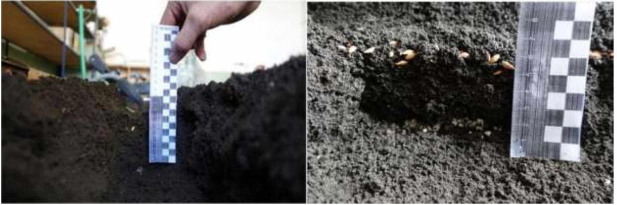
Рисунок 2.13 – Контроль глибини загортання насіння та добрив у лабораторних умовах
