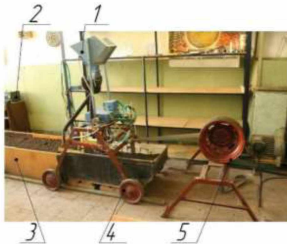
Рисунок 2.7 – Агрегат для проведення лабораторних досліджень з системою вібродискретного висіву
