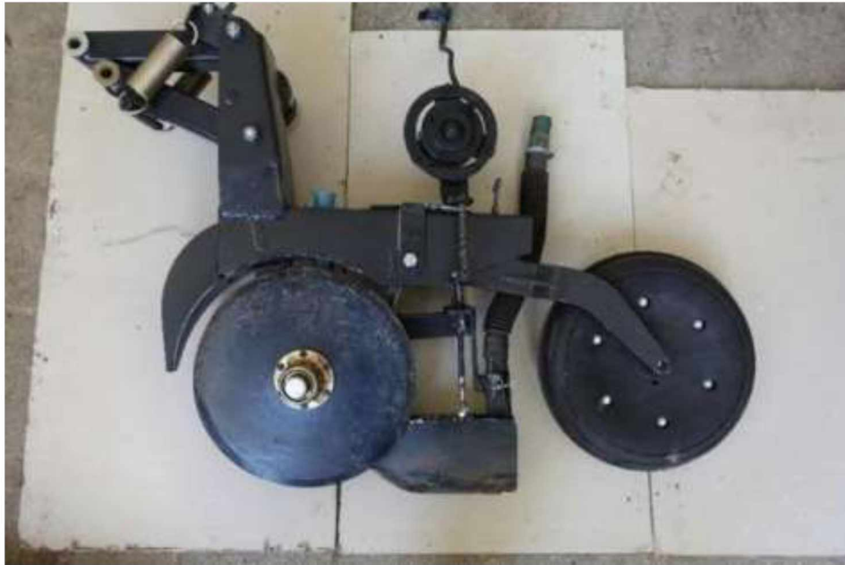
Рисунок 2.6 – Модернізований сошник сівалки «Деметра»
