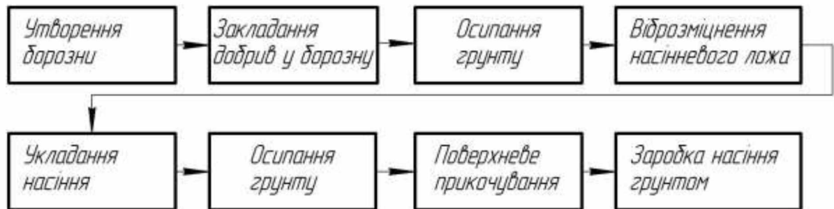
Рисунок 2.1 – Схема технологічного процесу одночасного закладення насіння та внесення добрив з розміщенням насіння над добривами
