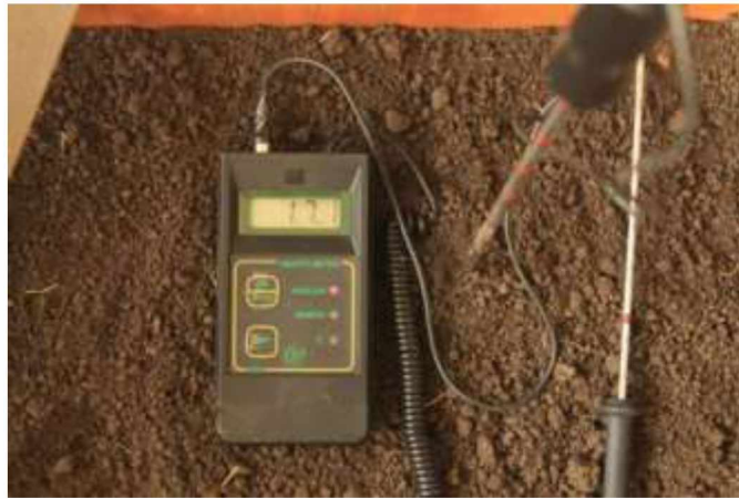
Рисунок 2.11 – Вимірювання показників вологості ґрунту
