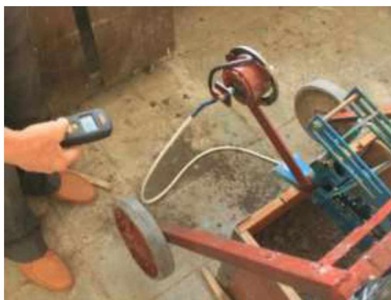
Рисунок 2.10 – Визначення частоти обертання електродвигуна
