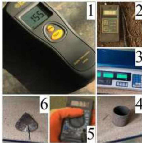
Рисунок 2.9 – Обладнання для проведення лабораторних досліджень: 1 – фотостробомер; 2 – вологомір; 3 – електронні ваги; 4 – труба; 5 – мультиметр; 6 – кельня
