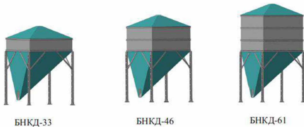
Рисунок 1.3 – Бункери – нагромаджувачі прямокутного перетину з конусним дном та боковим випускним отвором
