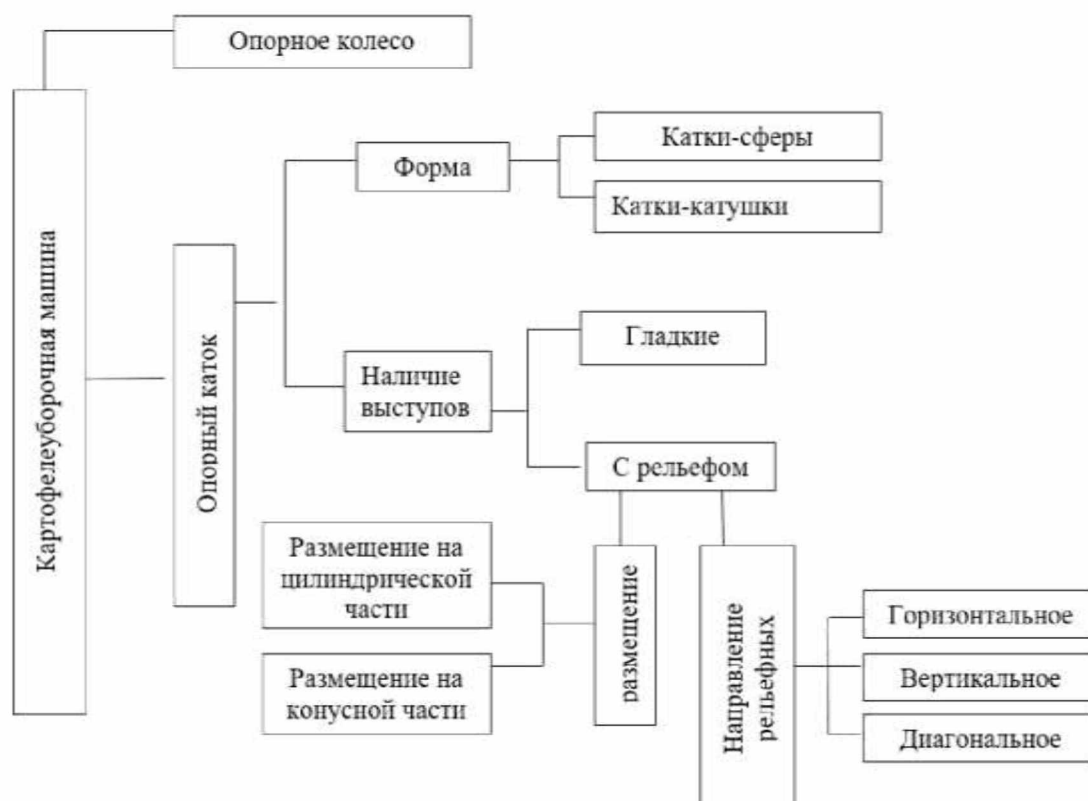
Рисунок 1.6 – Класифікаційна схема опорних котків
