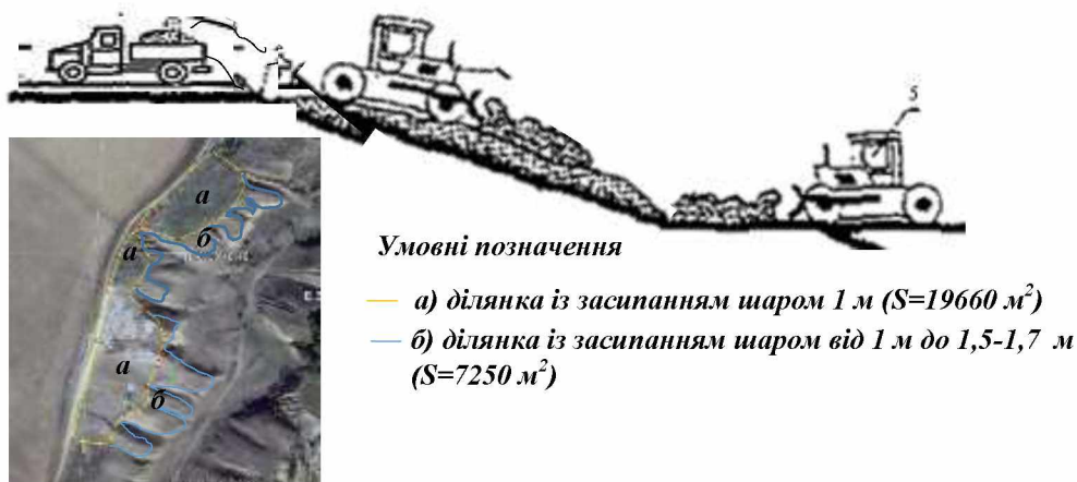
Рис.5.3 – Засипання землею території несанкціонованого звалища ТПВ в межах м. Берислав Херсонської області з урахуванням рельєфу
