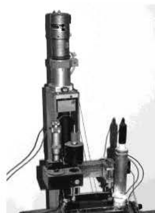
Рис. 3.6 – Автоматизований стенд для контролю залишкових напружень
