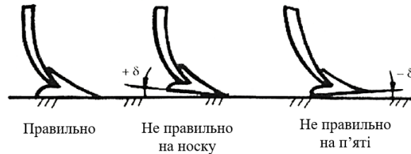
Рисунок 2 - Схеми роботи лап, культиватора з дволанковою підвіскою
