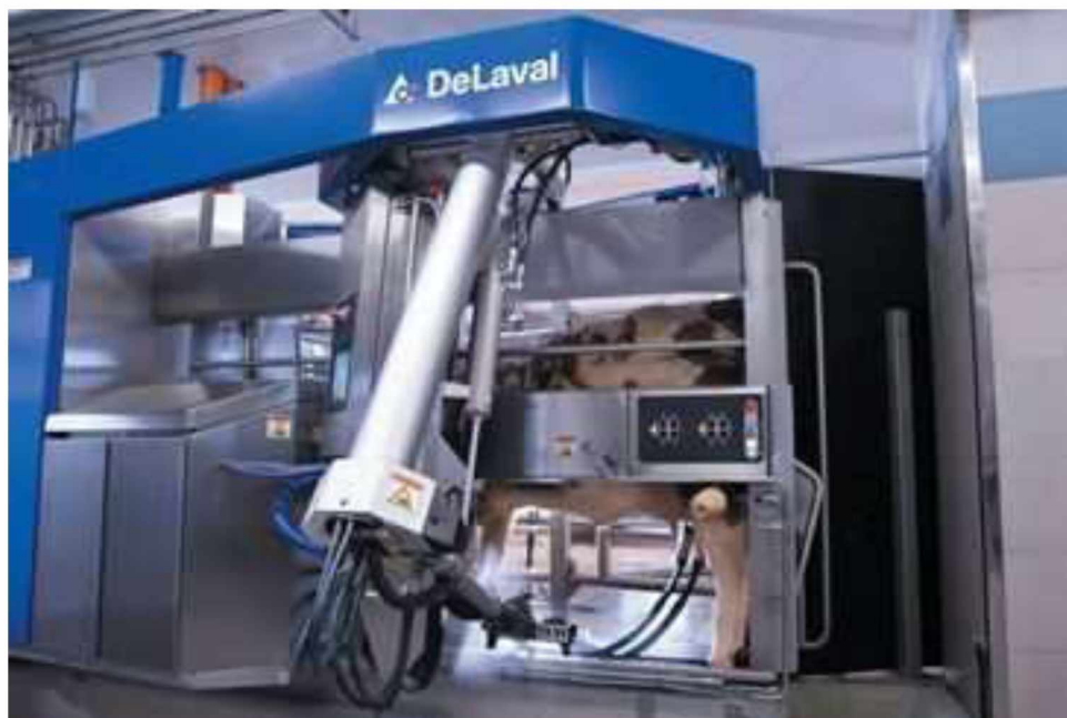
Рисунок 1.3- Доїльний робот установки виробника «ДеЛаваль»
