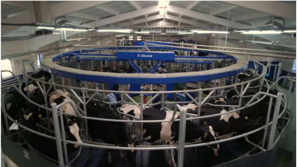
Рисунок 1.2- Роботизована доїльна установка виробника «ДеЛаваль»
