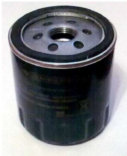
Рисунок 4.6 – Масляний фільтр, що складається із корпуса, отриманого за удосконаленою технологією
