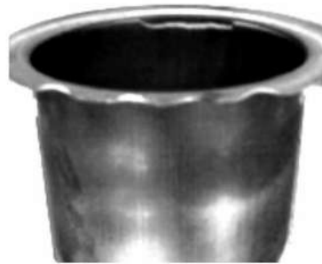
Рисунок 2.2 – Стакан із сталі 08Ю із кільцевою тріщиною (початковий радіус R_0 = 105 мм, радіус стакану 55 мм, висота 92 мм, товщина листа 0,5 мм)
