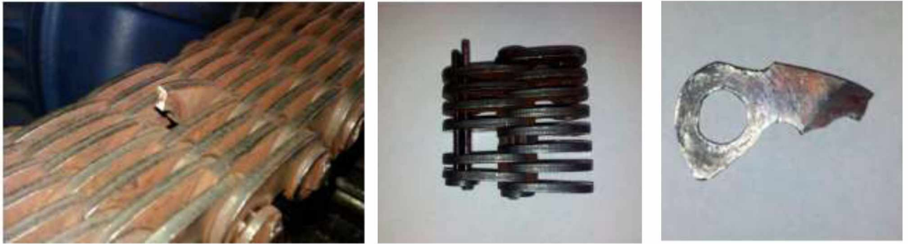
Рис. 3.5 – Втомне руйнування пластин зубчастого ланцюга при випробуваннях ланцюгових передач, що працюють без мастила
