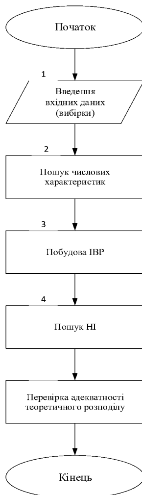
Рисунок 2.18 – Обчислювальний алгоритм побудови моделі потоку задач в ГРІД
