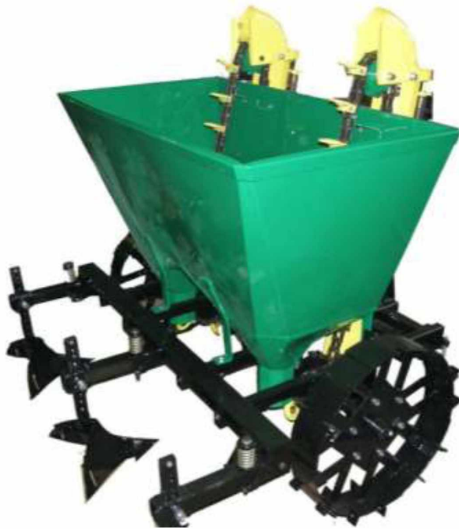
Рисунок 1.2 – робочі органи та загальний вид картоплесаджалки КС-2
