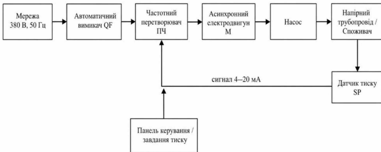
Рисунок 4.1 – Функціональна схема системи частотного керування насосною установкою
