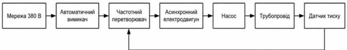
Рисунок 2.1 – Функціональну структуру системи керування насосною установкою
