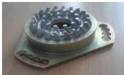
Рисунок 3.11 – Робочі органи подрібнювача фуражного зерна
