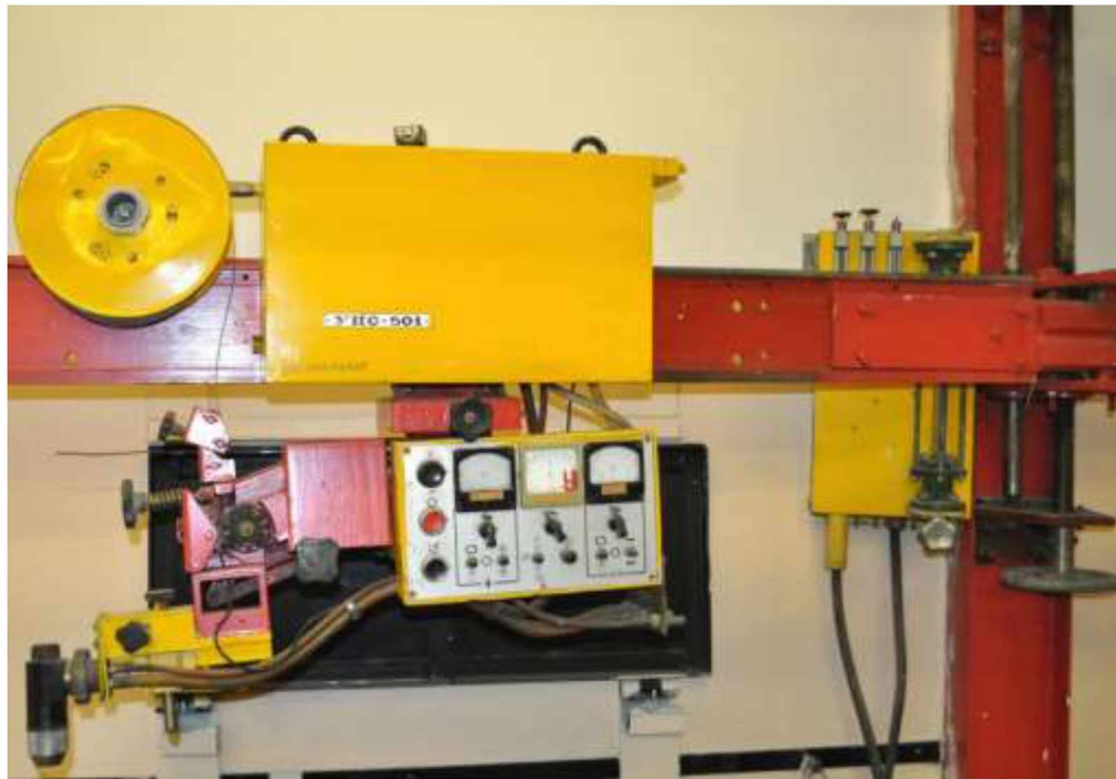
Рисунок 2.4 – Загальний вигляд установки для плазмової обробки деталей
