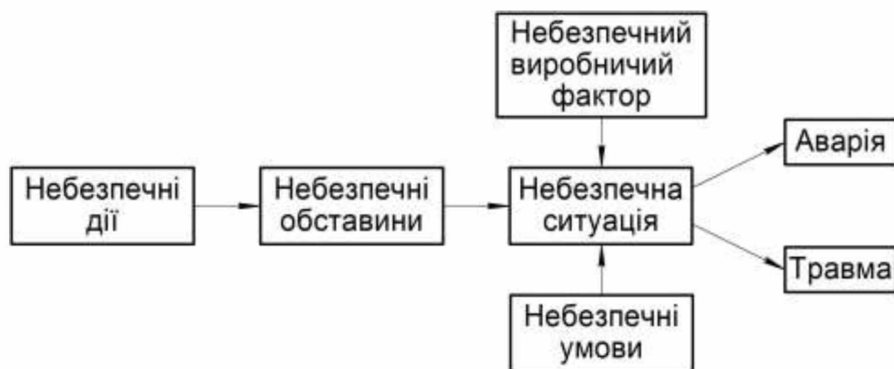
Рисунок 4.1 – Блок-схема формування та виникнення травмонебезпечних аварійних ситуацій
