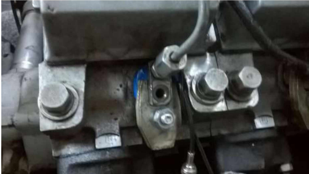
Рисунок 2.4 – Розміщення пристрою на дизелі в лабораторних умовах
