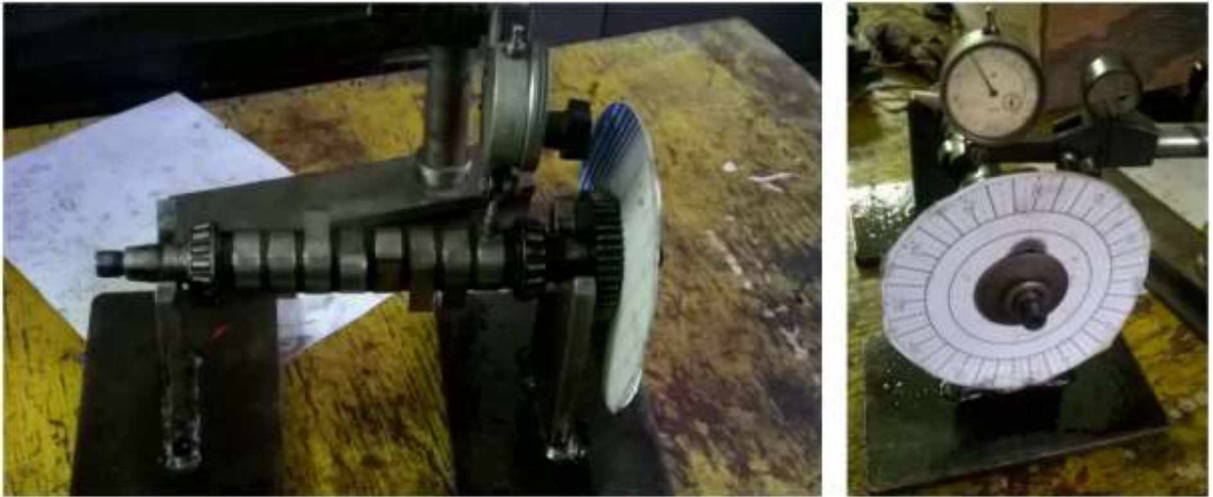
Рисунок 2.2 – Пристосування та прилади для вимірювання переміщення плунжера від повороту кулачкового валу ПНВТ дизеля сімейства КАМАЗ-740
