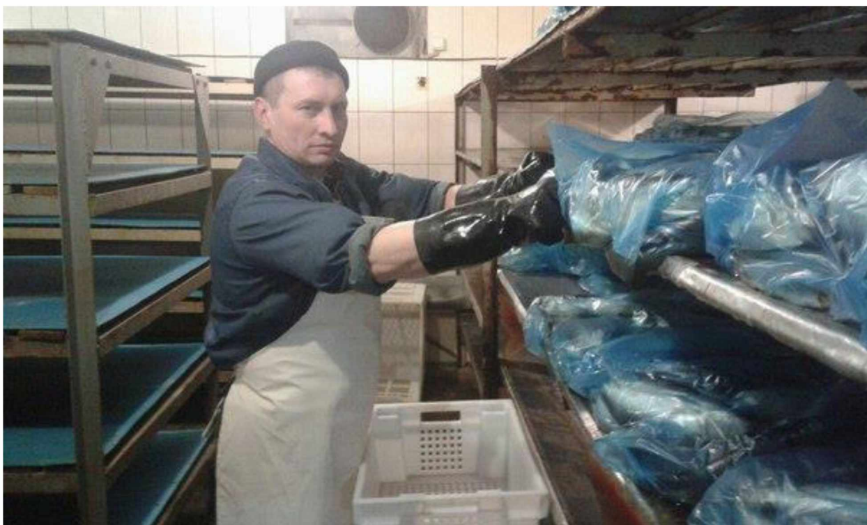
Рис. 3.4. Вкладання оселедців на стелажі для дефростації
