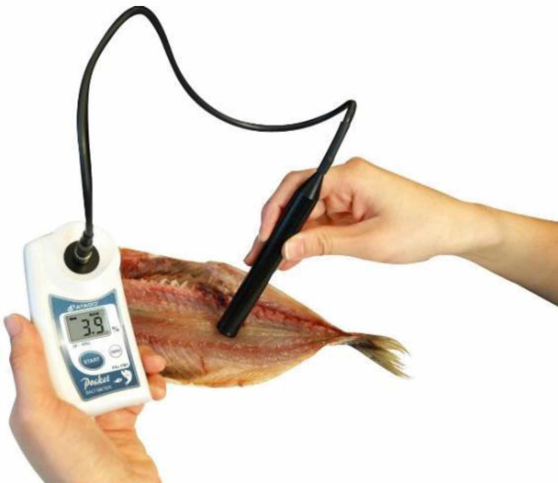
Рис. 3.8. Вимірювання вмісту солі у рибі приладом PAL-FM1.
