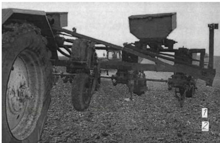
Рисунок 2.2 - Фрагмент посівного агрегату обладнаного стандартною (1) і багатофункціональною (2) сошниковими групами
