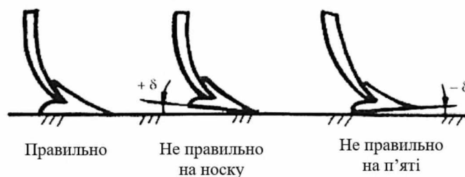
Рисунок 1.2 - Схеми роботи лап, при використанні культиватора з дволанковою підвіскою
