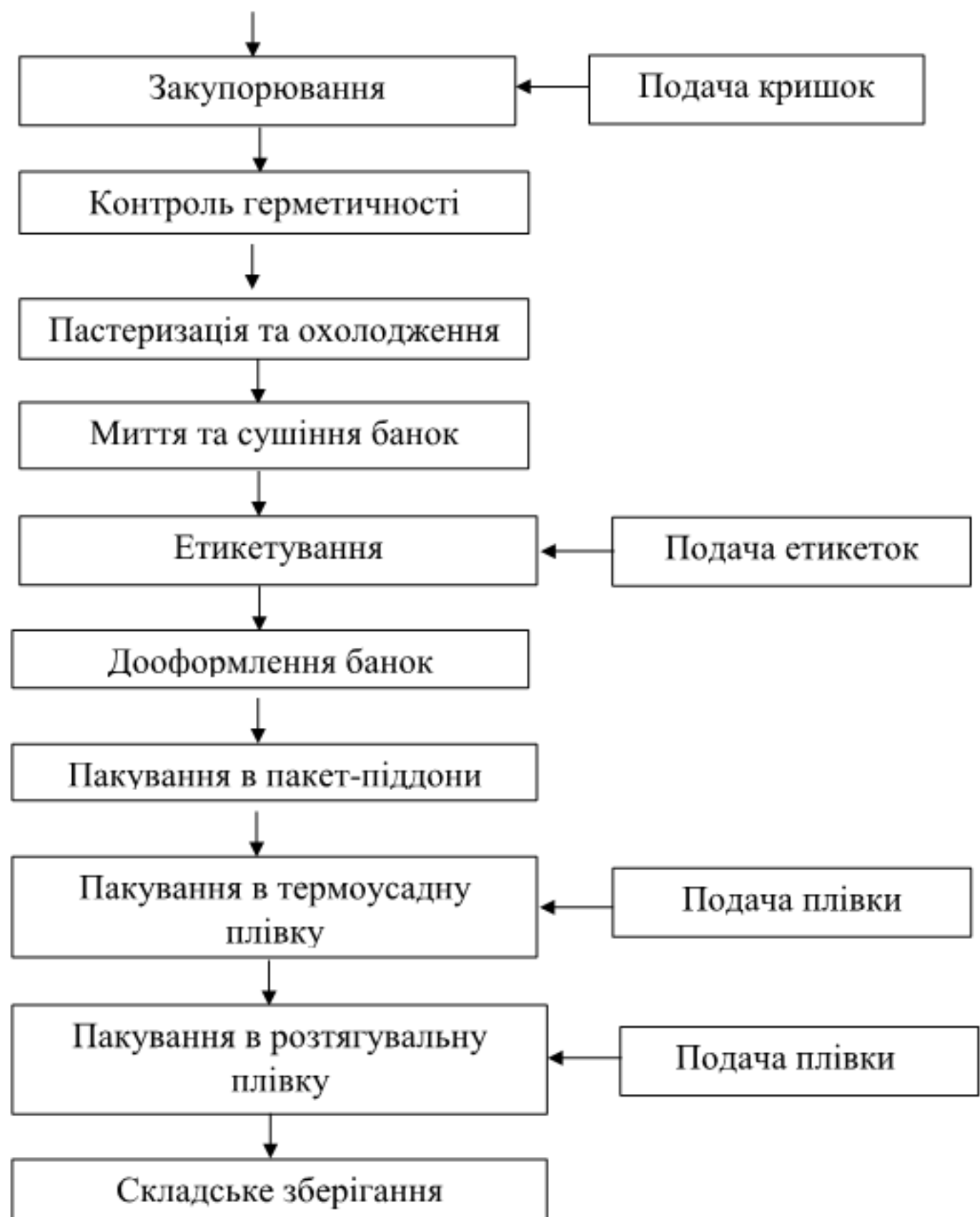
Рисунок 1.1 - Технологічна схема виробництва консервів «Сік вишневий з м'якоттю з цукром»
