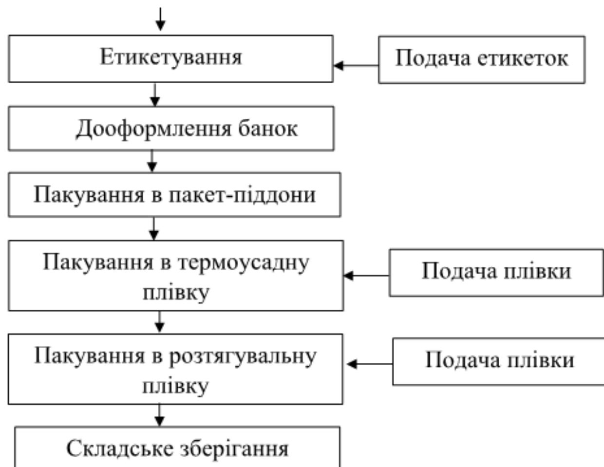
Рисунок А.1 - Технологічна схема виробництва консервів «Компот грушевий»
