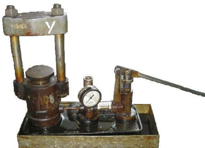
Рисунок 3.5 – Ручний гідравлічний прес
