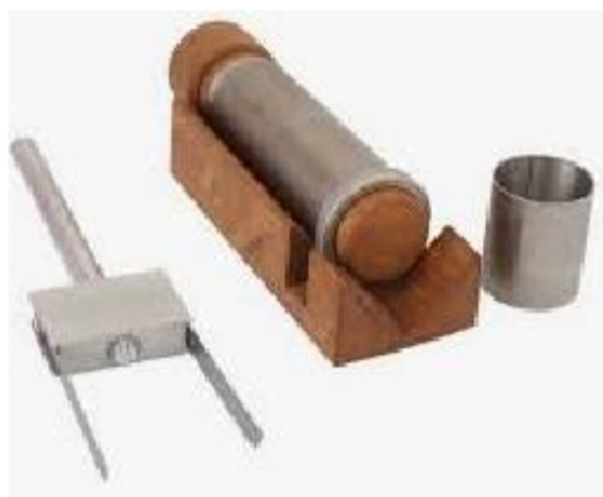
Рисунок 2.2 – Пробник Журавльова (визначення пористості хліба)
