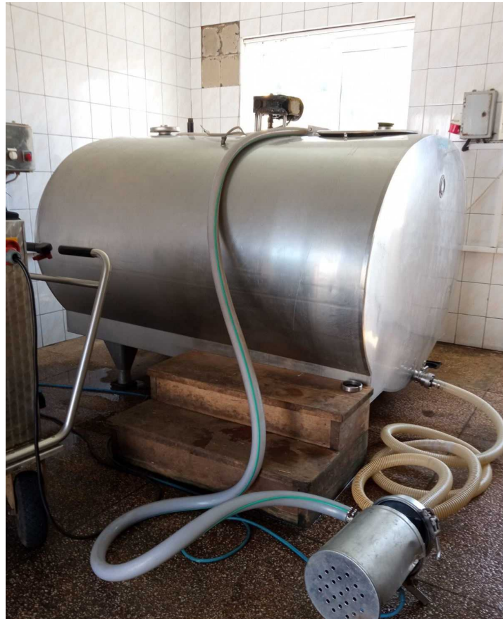
Рис. 3.10. Резервуар для зберігання молока
