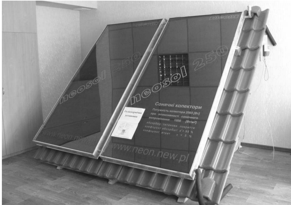
Рис. 3. Солнечные коллекторы neosol 250 в лаборатории ВИЭ
