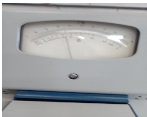
Рис. 1.20. Фіксація результатів визначення концентрації дослідної сполуки у кюветі відносно контрольних на табло ФЕКу
