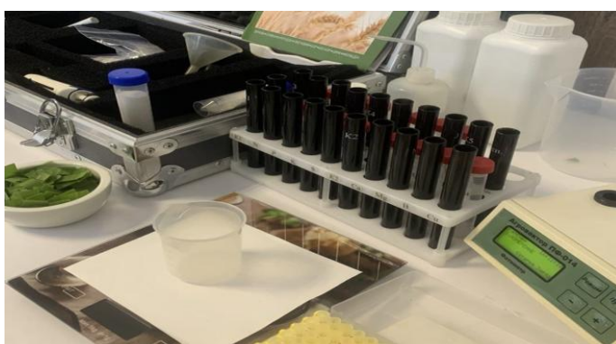
Рис. 2.3. Прилад для оцінки дефіциту або надлишку мінеральних елементів
