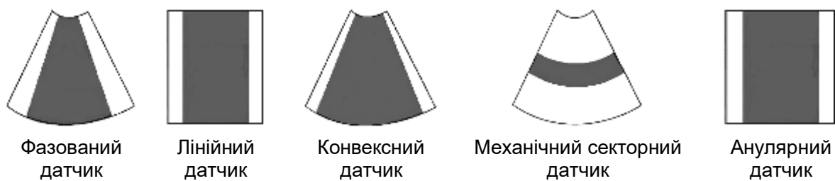
Рис. 5. Схематичне зображення поля візуалізації в залежності від типу датчика
