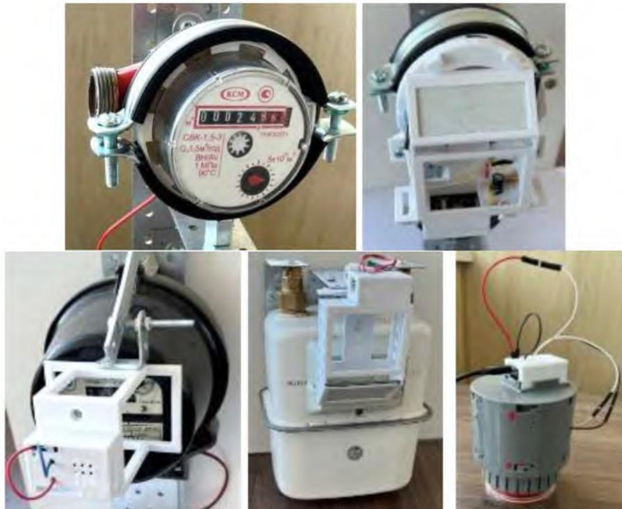
Рисунок 3.17 – Варіанти прототипів кріплення оптичного сенсора на аналогових лічильниках
