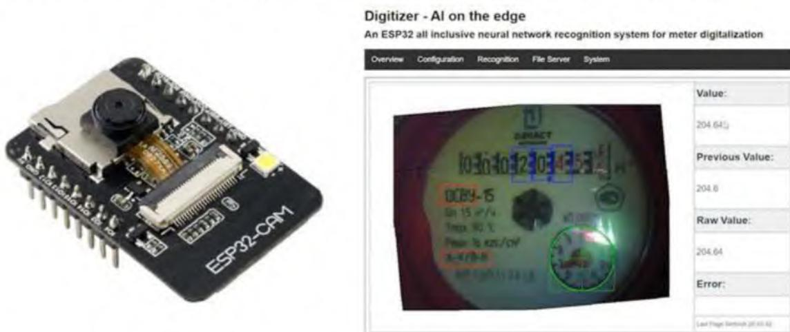
Рисунок 1.2 – Приклад оптичного зняття показань лічильника води [7]
